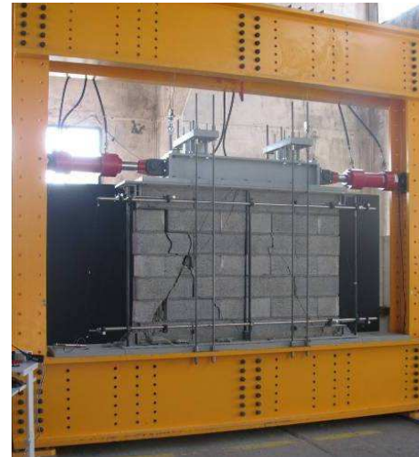
Reforço sísmico de alvenarias ⇨ FH Fribourg
